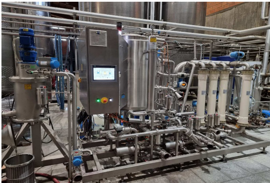
Cross – flow микрофилтрација – CFMF (Миланов 2021)
