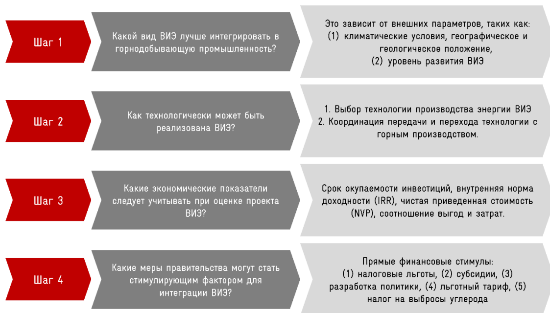
Рисунок 15: Как ВИЭ могут быть интегрированы в металлургическую промышленность
