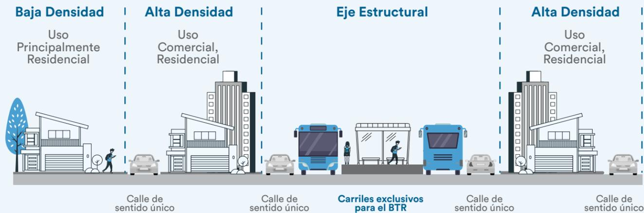
Curitiba -Sección conceptual a través del corredor de transporte
