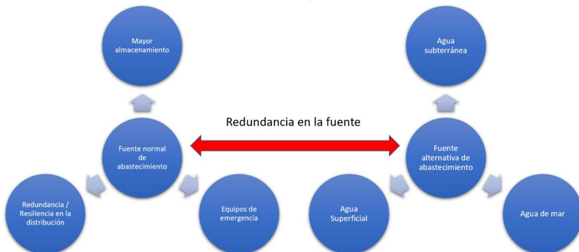
Figura 4.5 Esquema conceptual de infraestructura de abastecimiento de agua potable redundante (Elaboración propia, adaptado de Planning for Emergency Drinking Water Supply (EPA 2011))
