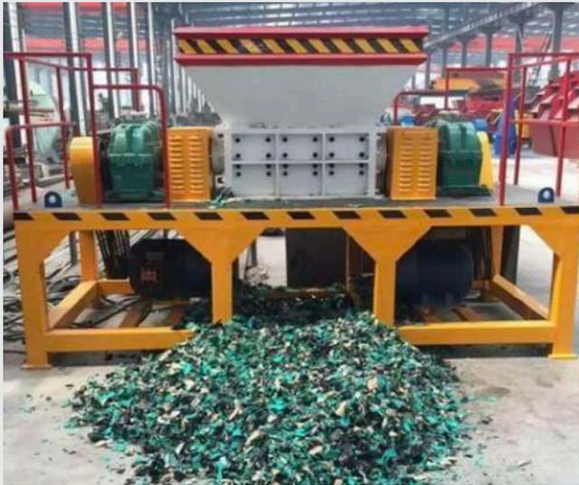
Figura 5. Fuente: <https://es.b2brazil.com/hotsite/henanlingheng/china-trituradora-de-metal-fabricante-do>. Trituradora de plástico (imagen).
