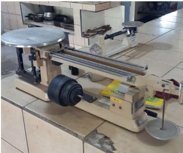
Figura 19. Fuente: Planta Codico Cayuga. Balanzas granatarias para peso de agregados.
