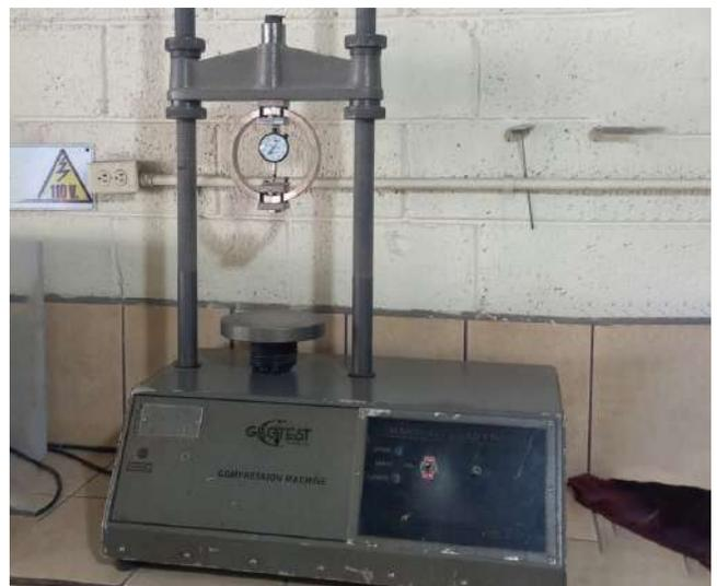
Figura 16. Fuente: Planta Codico Cayuga. Prensa Marshall.
