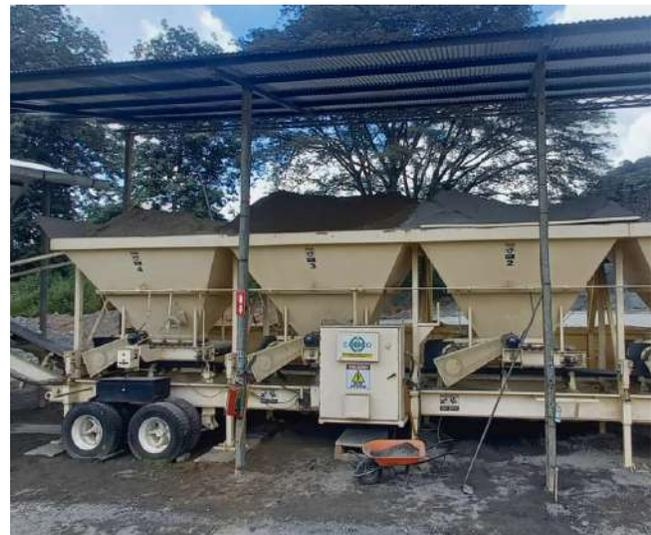
Figura 8. Fuente: Planta Codico Cayuga. Tolvas de dosificación de agregados pétreos.
