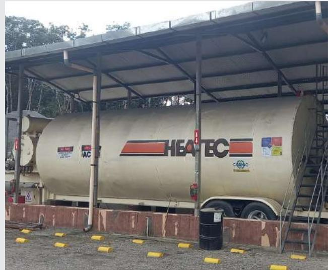
Figura 6. Fuente: Planta Codico Cayuga. Caldera y depósito de Cemento Asfáltico.
